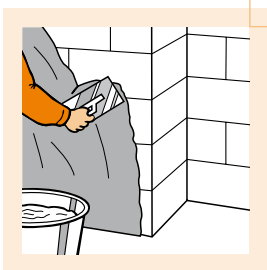
Obr. 17: Při lepení desek na stěny komínů se nanese vrstva lepicí malty FERMACELL přímo na zdivo a deska FERMACELL se do lepicí malty zatlačí
