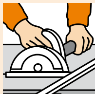
Obr. 4: Řezání elektrickou pilou
