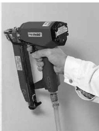
Upevňování sponkami na dřevěnou spodní konstrukci
